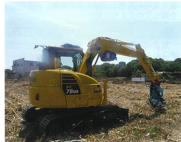
本年度に導入したグラップル(コマツ社製・PC78US-10) この一台で掘削・集積・集材が行えます
