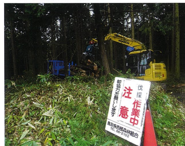
搬出間伐での材の積込(伯耆町大原地区) (グラップルで材をフォワーダへ積込んで運搬)
